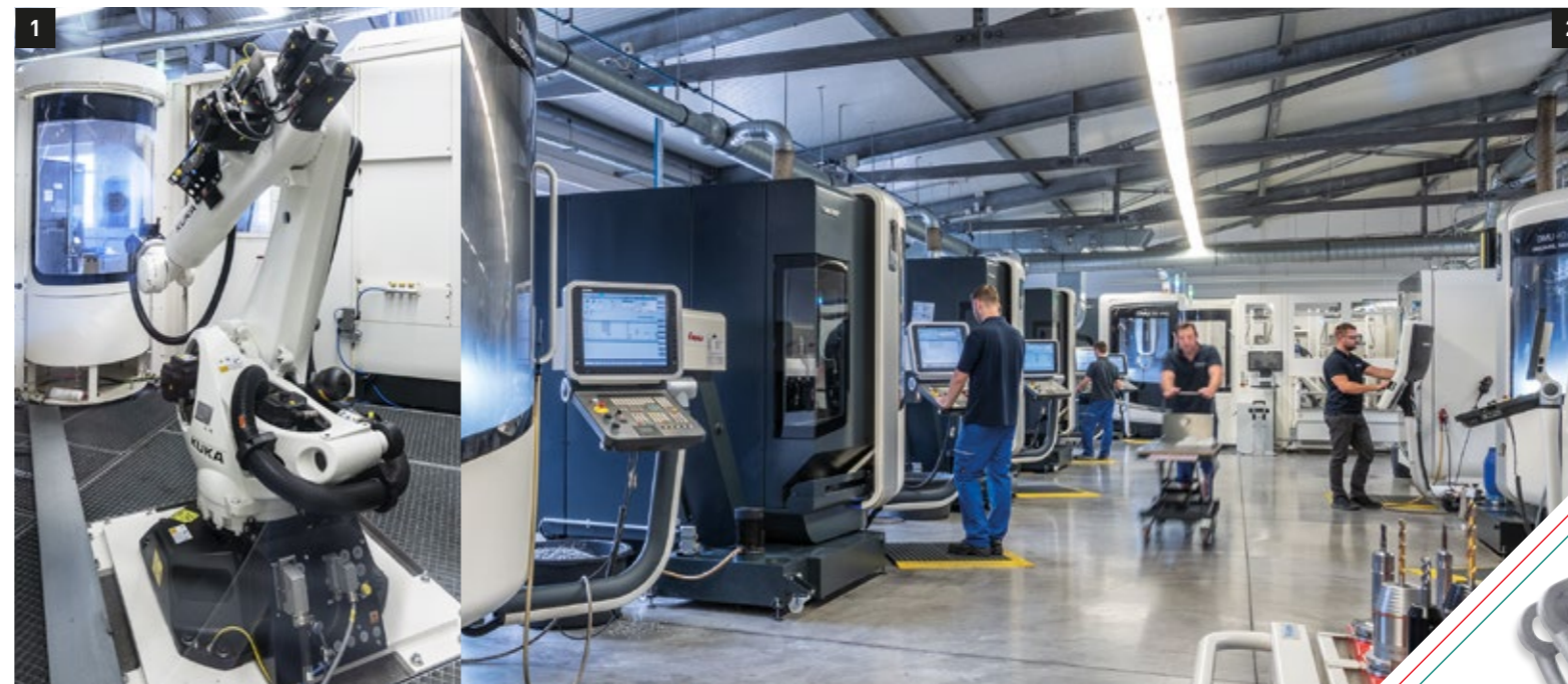
1. Der Kuka-Roboter bestückt die DMU60 eVo linear mit bis zu 20 Paletten oder Rohteilen. 2. DMG MORI beliefert Wehl & Partner mit 5-achsigen DMU eVo linear Bearbeitungszentren, Vertikalbearbeitungszentren der CMX V Serie und CTX Drehmaschinen.
